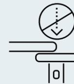
**| D | DER AUFFAHRSSCHUTZ** mit externem Gyro-Sensor erkennt, wenn die Tischplatte auf ein stabiles Hindernis trifft. Die Tischplatte stoppt und fährt in eine sichere Position zurück.
